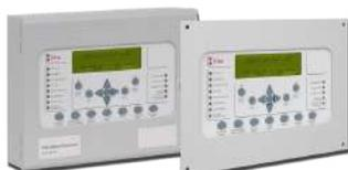
SYNCRO VIEW-A . Pannello ripetitore per centrali SYNCRO. Display grafico LCD 240 x 64 pixels. Ripete esattamente la centrale sia a livello di segnalazioni che di comando. Completo di alimentatore-carica batterie 230Vca; 750mA e chiave di abilitazione Batterie allocabili 2x1,9Ah-12V. Dimensioni 330 x 250 x 90mm.
