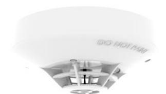
Rivelatore combinato termovelocimetrico + termico a risposta statica 90°C indicati dalla lettera "C", corrispondente alla "Classe C" e alla "Classe CR" nella classificazione EN54. Doppio led di segnalazione allarme visibile a 360°. Morsetto di uscita per lampada ripetitrice. Alimentazione 9,5-30 Vdc. Dim.: altezza 39 mm. diametro 100 mm. Colore BIANCO. Certificato EN 54-5: 2000 + A1:2002. Compatibile con le basi della serie YBN-R/6 e YBO-R/6.
