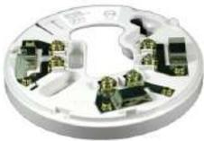
Base standard per rivelatori convenzionali serie CDX, contatti ad innesto autopulenti, morsetto d'appoggio per schermo, altezza 8 mm, diametro 100 mm. Colore AVORIO. Certificato LPCB, Lloyds Register, Germanischer Lloyd, MCA. Certificazione CE secondo MED (Marine Equipment Directive).
