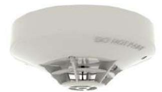
Rivelatore combinato termovelocimetrico + termico a risposta statica 60°C indicati dalla lettera "A", corrispondente alla "Classe A1" e alla "Classe A1R" nella classificazione EN54. Doppio led di segnalazione allarme visibile a 360°. Morsetto di uscita per lampada ripetitrice. Alimentazione 9,5-30 Vdc. Basso profilo altezza 39mm, diametro 100mm. Colore AVORIO. Certificato EN 54-5: 2000 + A1:2002. Compatibile con le basi della serie YBN-R/6 e YBO-R/6.
