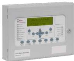
SYNCRO VIEW-A. Pannello ripetitore per centrali SYNCRO. Display grafico LCD 240 x 64 pixels. Ripete esattamente la centrale sia a livello di segnalazioni che di comando. Completo di alimentatore-carica batterie 230Vca-750mA e chiave di abilitazione. Batterie allocabili 2x1,9Ah-12V. Dimensioni 330 x 250 x 90mm.
