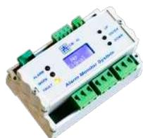
Centralina montaggio barra DIN - 1 ingresso 4-20mA + 3 uscite relè (2 livelli di allarme + Guasto) Livelli di allarme programmabili da operatore Tipo gas, unità di misura impostabili solo di fabbrica su richiesta del cliente. Alimentazione 12/24Vdc.
