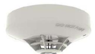
Rivelatore combinato termovelocimetrico + termico a risposta statica 90°C indicati dalla lettera "C", corrispondente alla "Classe C" e alla "Classe CR" nella classificazione EN54. Doppio led di segnalazione allarme visibile a 360°. Morsetto di uscita per lampada ripetitrice. Alimentazione 9,5-30 Vdc. Basso profilo altezza 39mm, diametro 100mm. Colore AVORIO. Certificato EN 54-5: 2000 + A1:2002. Compatibile con le basi della serie YBN-R/6 e YBO-R/6.
