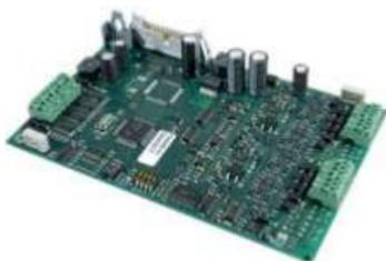
SOLUTION F1. Modulo a 2 loop o 8 linee aperte ridontato e certificato SIL2per rivelatori analogico indirizzati con protocollo Hochiki ESP. 8 uscite O.C. programmabili. Controllo integrita` schermo (apertura o corto con cavi +/- del loop). Assorbimento a riposo 40mA. Max. corrente per il loop 300mA. Dimensioni 170x110x20 mm
