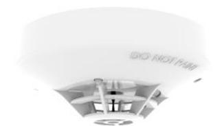
Rivelatore combinato termovelocimetrico + termico a risposta statica 60°C indicati dalla lettera "A", corrispondente alla "Classe A" e alla "Classe AR" nella classificazione EN54. Doppio led di segnalazione allarme visibile a 360°. Morsetto di uscita per lampada ripetitrice. Alimentazione 9,5-30 Vdc. Basso profilo altezza 39mm, diametro 100mm. Colore BIANCO. Certificato EN 54-5: 2000 + A1:2002. Compatibile con le basi della serie YBN-R/6 e YBO-R/6.
