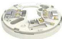
Base standard per rivelatori convenzionali a sicurezza intrinseca; contatti ad innesto autopulenti, morsetto d'appoggio per schermo. Colore AVORIO altezza 8mm diametro 100mm.
