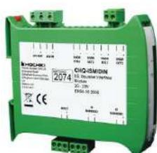
Modulo di interfaccia per avvisatori ottico-acustici a sicurezza intrinseca collegati ai moduli avvisatori CHQ-DSC2 o alle uscite avvisatori di centrale. Dotato di 2 uscite per avvisatori (max. 1 avvisatore o lampeggiante per uscita) e 1 ingresso monitorato. Alimentazione esterna 24Vcc. Contenitore per montaggio su barra DIN. Morsettiere estraibili. Dimensioni 119x108x24mm. Certificato EN 54-18:2005. Necessita di barriera Zener cod. IAPBZ928
