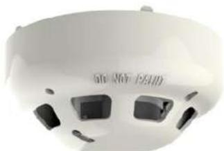
Rivelatore di Fumo Fotoelettronico convenzionale con tecnologia ASWV (drift Compensation technology) che garantisce che il rivelatore stia operando alla sensibilità ottimale per evitare falsi allarmi. Camera ottica rimovibile, led di segnalazione allarme. Morsetto di Uscita per lampada Ripetitrice. Alimentazione 9,5-30 Vdc. Basso profilo altezza 45mm, diametro 100mm. Colore AVORIO. Certificato EN 54-7: 2000 + A1:2002. Compatibile con le basi della serie YBN-R/6 e YBO-R/6.
