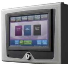
Pannello remoto VISION con display LCD grafico a colori da 7", 800x480 pixels con funzionalità Touch-screen di tipo resistivo e attenuazione automatica della retroilluminazione, completo di scheda di rete RS485 cod. HLA-AP-LNC. Consente la ripetizione di tutte le informazioni delle centrali L@titude in rete e la piena operatività della centrale. Grado di protezione IP30 peso 2Kg dimensione 235(L)x170(A)x55(P)mm. Alimentazione 24Vdc . Richiede la scheda di rete in centrale.
