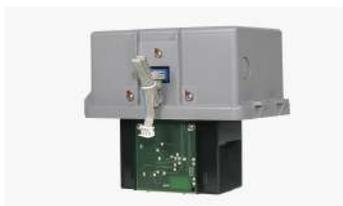
Rivelatore ottico ad alta sensibilità per unità di analisi ASD 531. Sensibilità allarme: min. 10%-max.0.02 %. Il preallarme può essere impostato fino a 10 volte più sensibile. Es. 0.002% obs/m. Temperatura di lavoro -20°C a + 60°C. Dimensioni: 95 (L) x 145 (H) x 120 (P) mm.
