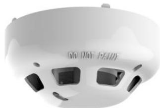
Rivelatore di Fumo Fotoelettronico convenzionale con tecnologia ASWV (drift Compensation technology) che garantisce che il rivelatore stia operando alla sensibilità ottimale per evitare falsi allarmi. Camera ottica rimovibile, led di segnalazione allarme. Morsetto di Uscita per lampada Ripetitrice. Alimentazione 9,5-30 Vdc. Basso profilo altezza 45mm, diametro 100mm. Colore BIANCO. Certificato EN 54-7: 2000 + A1:2002. Compatibile con le basi della serie YBN-R/6 e YBO-R/6.
