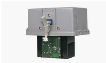
Rivelatore ottico ad alta sensibilità per unità di analisi ASD 535. Sensibilità allarme: min. 10%-max.0.02 %. Il preallarme può essere impostato fino a 10 volte più sensibile. Es. 0.002% obs/m. Temperatura di lavoro -30°C a + 60°C. Dimensioni: 95 (L) x 145 (H) x 120 (P) mm.R
