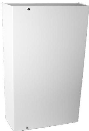
Centralina di controllo FIREscape, due linee per il controllo delle lampade di emergenza/evacuazione. L'EL-2 alimenta le unità luminose in condizioni normali, eseguendo un test continuo e di monitoraggio delle apparecchiature presenti sul sistema. Tutti gli eventi vengono salvati nella memoria della centrale e sono accessibili tramite una tastiera ELKP collegata alla centrale tramite RS485. NOTA: E' necessario il trasformatore EL-35V.
