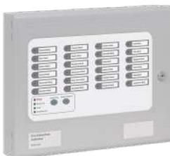
SYNCRO IDENT24. Pannello ripetitore 24Led. Connessione alla centrale tramite RS485. Munito di Buzzer, comandi di tacitazione/riattivazione e Lamp test. Alimentazione da 18-30Vcc. Dimensioni 385x310x60 mm. Contenitore in acciaio verniciato grigio BS-00-A-05, colore frontale grigio RAL7047.
