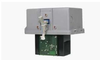
Rivelatore ottico ad alta sensibilità per unità di analisi ASD 532. Sensibilità allarme: min. 10%-max.0.02 %. Il preallarme può essere impostato fino a 10 volte più sensibile. Es. 0.002% obs/m. Temperatura di lavoro -20°C a + 60°C. Dimensioni: 95 (L) x 145 (H) x 120 (P) mm.
