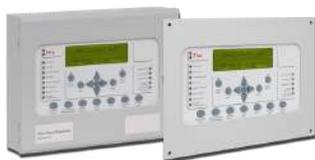
SYNCRO VIEW. Pannello ripetitore per centrali SYNCRO. Display grafico LCD 240 x 64 pixels. Ripete esattamente la centrale sia a livello di segnalazioni che di comando. Con chiave di abilitazione. Alimentazione 24Vdc. Dimensioni 330 x 250 x 90mm.
