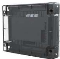
Modulo di interfaccia per avvisatori ottico-acustici a sicurezza intrinseca collegati ai moduli avvisatori CHQ-DSC2(SCI) o alle uscite avvisatori di centrale. Dotato di 2 uscite per avvisatori (max. 1 avvisatore o lampeggiante per uscita) e 1 ingresso monitorato. Alimentazione esterna 24Vcc. Contenitore "Smart Fix" con coperchio trasparente. Dimensioni 157x127x35mm. Certificato EN 54-18:2005. Necessita di barriera Zener cod. IAPBZ928
