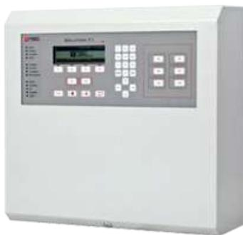
Contenitore A1 per Solution F1-6, max 3 posti scheda, senza predisposizione per montaggio LED di zona. Batterie alloggiabili max. 2x17Ah. Dimensioni 490x540x158 mm.
