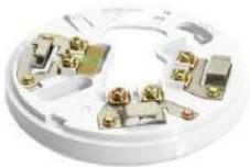
Base standard per rivelatori convenzionali a sicurezza intrinseca; contatti ad innesto autopulenti, morsetto d'appoggio per schermo. Colore BIANCO altezza 8mm diametro 100mm.
