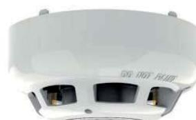
Rivelatore combinato fotoelettronico e di temperatura analogico indirizzato, con isolatore di corto circuito e nuova camera di rivelazione High Performance, indirizzamento elettronico, camera ottica rimovibile, doppio Led di segnalazione (verde in polling, ambra se isolato, rosso in allarme), consumo 400 microA, basso profilo, altezza 45mm, diametro 100 mm. Colore BIANCO. Certificato EN 54-5 e EN 54-7. Compatibile con le basi della serie YBV-R/4(WHT).
