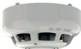
Rivelatore combinato fotoelettronico e di temperatura analogico indirizzato certificato SIL2, con nuova camera di rivelazione High Performance, indirizzamento elettronico, camera ottica rimovibile, doppio Led di segnalazione (verde in polling, rosso in allarme), consumo 400 microA, basso profilo, altezza 45mm, diametro 100 mm. Colore AVORIO. Certificato EN 54-5 e EN 54-7. Compatibile con le basi YBN-R/3(WHT)-SCI/SIL e YBN-R/3(WHT).
