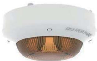
Lampeggiante analogico indirizzato, LED ad alta intensita` per una visibilita` eccellente anche in condizioni sfavorevoli di luminosit`. Basso assorbimento e alimentazione diretta dal loop. Frequenza di lampeggio 1Hz. Colore BIANCO e lampeggiante AMBRA. Compatibile con le basi della serie YBN-R/3(WHT) o YBN-R/3(WHT)-SCI o sirene YBO-BS(WHT) e YBO-BSB2/..(WHT).
