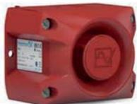
Sirena elettronica per completa di back box per entrata cavi, potenza acustica 100 dB (portata EN54 r=18m), 80 toni selezionabili, alimentazione 10-57Vdc assorbimento 6-80mA, temperatura di funzionamento -40° +55°C. Contenitore in policarbonato e ABS di colore ROSSO, dimensioni 110x86x80 mm (LxHxP). Grado di protezione IP66. Certificata EN 54-3, VdS, GOST, UL, GL (codice d'ordine specifico per GL).
