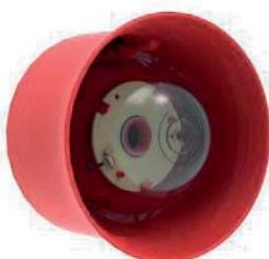
Sirena basso assorbimento completa di lampeggiante a led ROSSI, indirizzata su loop per montaggio a parete, 51 tonalita` selezionabili, volume selezionabile da 90 a 102 dB(A), tempo di suonata impostabile fino a 18 ore. Categoria di appartenenza del flash "O". Colore ROSSO. Grado di protezione IP21 innalzabile al grado di protezione IP65 con l'utilizzo dell'accessorio cod. CHQ-WPK. Certificata EN54-3 e EN54-23. Compatibile con le basi della serie YBO-R/3(RED), YBO-R/SCI(RED).
