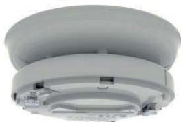
Sirena basso assorbimento indirizzata su loop. 51 tonalita` selezionabili, volume selezionabile da 50 a 98 dB(A), tempo di suonata impostabile fino a 18 ore. Colore AVORIO. Puo` fungere da base per un rivelatore o essere montata da sola con coperchio SI/CAP2. Certificata EN54-3. Compatibile con le basi della serie YBN-R/3 e YBN-R/3(SCI).
