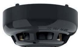
Rivelatore combinato fotoelettronico e di temperatura analogico indirizzato, con nuova camera di rivelazione High Performance, indirizzamento elettronico, camera ottica rimovibile, doppio Led di segnalazione (verde in polling, rosso in allarme), consumo 400 microA, basso profilo, altezza 45mm, diametro 100 mm. Colore NERO. Certificato EN 54-5 e EN 54-7. Compatibile con le basi della serie YBN-R/3(BLK).
