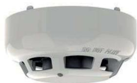
Rivelatore di fumo fotoelettronico analogico indirizzato con isolatore di corto circuito e nuova camera di rivelazione High Performance, indirizzamento elettronico, camera ottica rimovibile, doppio Led di segnalazione (verde in polling, ambra se isolato, rosso in allarme), consumo 120 microA in Low Power, basso profilo, altezza 45 mm, diametro 100 mm. Colore BIANCO. Certificato EN 54-7. Compatibile con le basi della serie YBV-R/4(WHT).
