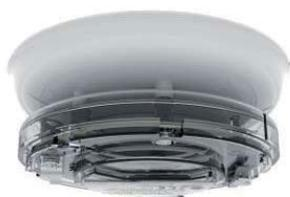
Sirena con lampeggiante a led BIANCHI, basso assorbimento, indirizzata e alimentata dal loop. 51 tonalita` selezionabili, volume selezionabile da 50 a 98 dB(A). Categoria di appartenenza del flash "O". Colore BIANCO. Può fungere da base per un rivelatore o essere montata da sola con coperchio SI/CAP2(WHT). Grado di protezione IP21. Certificata EN 54-3 e EN 54-23. Compatibile con le basi della serie YBN-R/3(WHT) e YBN-R/3(SCI)WHT.
