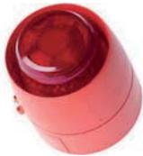
Sirena convenzionale da parete a basso assorbimento, combinata con lampeggiante NON certificato EN54-23, potenza acustica 113 dB a 1 m. (tono 15), 32 toni selezionabili. Alimentazione 21-28Vdc assorbimento 10,8-34,4mA, temperatura di funzionamento da -20°C a +40°C. Contenitore di colore ROSSO, altezza 86,6mm diametro 93,6 mm, grado di protezione IP21. Certificata EN 54-3.
