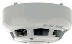
Rivelatore combinato termomassimale + termovelocimetrico analogico indirizzato, indirizzamento elettronico, doppio Led di segnalazione (verde in polling, rosso in allarme), consumo 350 microA, basso profilo, altezza 45mm, diametro 100 mm. Colore AVORIO. Certificato EN54-5. Compatibile con le basi della serie YBN-R/3 e YBN-R/3(SCI).
