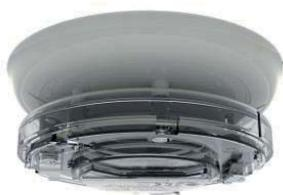
Sirena con lampeggiante a led BIANCHI, basso assorbimento, indirizzata e alimentata dal loop. 51 tonalita` selezionabili, volume selezionabile da 50 a 98 dB(A). Categoria di appartenenza del flash "O". Colore AVORIO. Può fungere da base per un rivelatore o essere montata da sola con coperchio SI/CAP2. Grado di protezione IP21. Certificata EN 54-3 e EN 54-23. Compatibile con le basi della serie YBN-R/3(WHT) e YBN-R/3(SCI)WHT.
