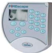
EL-KP è una tastiera della centralina di controllo per l'illuminazione di emergenza da utilizzare con la centrale EL-2. La centrale di controllo viene comandata e controllata tramite il display grafico LCD retroilluminato e compatto della tastiera, che può visualizzare lo stato del sistema delle unità di illuminazione, inclusi la carica della batteria e i guasti ai LED. Una centrale di controllo EL-2 può supportare un totale di 8 tastiere EL-KP.
