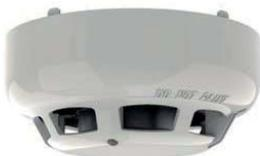
Rivelatore di fumo fotoelettronico analogico indirizzato, con nuova camera di rivelazione High Performance, indirizzamento elettronico, camera ottica rimovibile, doppio Led di segnalazione (verde in polling, rosso in allarme), consumo 120 microA in Low Power, basso profilo, altezza 45 mm, diametro 100 mm. Colore AVORIO. Certificato EN 54-7. Compatibile con le basi della serie YBN-R/3 e YBN-R/3(SCI).
