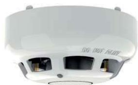
Rivelatore combinato termomassimale + termovelocimetrico analogico indirizzato, con isolatore di corto circuito, indirizzamento elettronico, doppio Led di segnalazione (verde in polling, ambra se isolato, rosso in allarme), consumo 350 microA, basso profilo, altezza 45mm, diametro 100 mm. Colore BIANCO. Certificato EN54-5. Compatibile con le basi della serie YBV-R/4(WHT).
