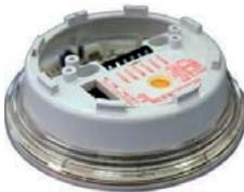
Sirena convenzionale da parete a basso assorbimento, combinata con lampeggiante NON certificato EN54-23, potenza acustica 113 dB a 1 m. (tono 15), 32 toni selezionabili. Alimentazione 21-28Vdc assorbimento 10,8-34,4mA, temperatura di funzionamento da -20°C a +40°C. Contenitore di colore BIANCO, altezza 86,6mm diametro 93,6 mm. Grado di protezione IP21. Certificata EN 54-3.
