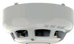
Rivelatore combinato termomassimale + termovelocimetrico analogico indirizzato certificato SIL2, indirizzamento elettronico, doppio Led di segnalazione (verde in polling, rosso in allarme), consumo 350 microA, basso profilo, altezza 45mm, diametro 100 mm. Colore AVORIO. Certificato EN54-5. Compatibile con le basi YBN-R/3(WHT)-SCI/SIL e YBN-R/3(WHT).
