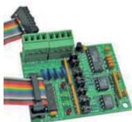
Modulo di espansione delle porte seriali della centrale EL-2. Integra due porte seriali aggiuntive che possono essere configurate come RS232 oppure RS485.
