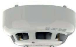
Rivelatore combinato fotoelettronico e di temperatura analogico indirizzato, con nuova camera di rivelazione High Performance, indirizzamento elettronico, camera ottica rimovibile, doppio Led di segnalazione (verde in polling, rosso in allarme), consumo 400 microA, basso profilo, altezza 45mm, diametro 100 mm. Colore AVORIO. Certificato EN 54-5 e EN 54-7. Compatibile con le basi della serie YBN-R/3 e YBN-R/3(SCI).
