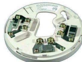
Base standard per rivelatori convenzionali a sicurezza intrinseca; contatti ad innesto autopulenti, morsetto d'appoggio per schermo. Colore AVORIO altezza 8mm diametro 100mm.
