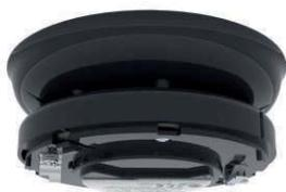
Sirena basso assorbimento indirizzata su loop. 51 tonalita` selezionabili, volume selezionabile da 50 a 98 dB(A), tempo di suonata impostabile fino a 18 ore. Colore NERO. Puo` fungere da base per un rivelatore. Grado di protezione IP21. Certificata EN54-3. Compatibile con le basi della serie YBN-R/3(BLK).
