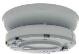
Sirena basso assorbimento indirizzata su loop certificata SIL2. 51 tonalità selezionabili, volume selezionabile da 50 a 98 dB(A), tempo di suonata impostabile fino a 18 ore. Colore AVORIO. Può fungere da base per un rivelatore o essere montata da sola con coperchio SI/CAP2. Temperatura di funzionamento -10°C +50°C. Grado di protezione IP21. Certificata EN54-3. Compatibile con le basi della serie YBN-R/3 e YBN-R/3(SCI)/SIL.
