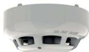
Rivelatore di fumo fotoelettronico analogico indirizzato con isolatore di corto circuito e nuova camera di rivelazione High Performance, indirizzamento elettronico, camera ottica rimovibile, doppio Led di segnalazione (verde in polling, ambra se isolato, rosso in allarme), consumo 120 microA in Low Power, basso profilo, altezza 45 mm, diametro 100 mm. Colore AVORIO. Certificato EN 54-7. Compatibile con le basi della serie YBV-R/4.
