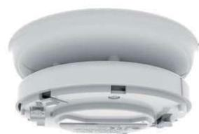
Sirena basso assorbimento indirizzata su loop. 51 tonalita` selezionabili, volume selezionabile da 50 a 98 dB(A), tempo di suonata impostabile fino a 18 ore. Colore BIANCO. Puo` fungere da base per un rivelatore o essere montata da sola con coperchio SI/CAP2(WHT). Grado di protezione IP21. Certificata EN54-3. Compatibile con le basi della serie YBN-R/3(WHT) e YBN-R/3(SCI)WHT.
