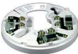
Base standard per rivelatori convenzionali serie CDX, contatti ad innesto autopulenti, morsetto d'appoggio per schermo, altezza 8 mm, diametro 100 mm. Colore BIANCO.
