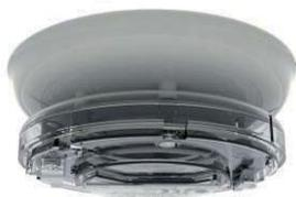
Sirena con lampeggiante a led ROSSI, basso assorbimento, indirizzata e alimentata dal loop. 51 tonalita` selezionabili, volume selezionabile da 50 a 98 dB(A). Categoria di appartenenza del flash "O". Colore AVORIO. Puo` fungere da base per un rivelatore o essere montata da sola con coperchio SI/CAP2. Grado di protezione IP21. Certificata EN 54-3 e EN 54-23. Compatibile con le basi della serie YBN-R/3 e YBN-R/3(SCI).
