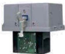
Rivelatore ottico ad alta sensibilità per unità di analisi ASD 531. Sensibilità allarme: min. 10%-max.0.02 %. Il preallarme può essere impostato fino a 10 volte più sensibile. Es. 0.002% obs/m. Temperatura di lavoro -20°C a + 60°C. Dimensioni: 95 (L) x 145 (H) x 120 (P) mm.
