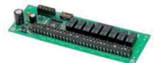
Scheda di espansione a 8 zone convenzionali. Da installare negli slot E-F per il contenitore a 4 slot ed E-F e G-K per quello a 8 slot.
