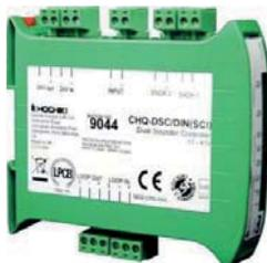
Modulo indirizzato su loop con 2 uscite controllate per avvisatori (carico max. 1A ognuna) e 1 ingresso monitorato. Alimentazione esterna 24Vcc 2A, consumo sul loop a riposo 350 microA. Led di segnalazione. Contenitore per montaggio su barra DIN. Morsettiere estraibili. Dimensioni 119x108x24mm. Completo di isolatori di cortocircuito integrati direttamente sul modulo. Certificato EN 54-18:2005 ed EN 54-17:2005. Indirizzamento tramite dip switch presenti sul modulo.
