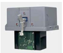
Rivelatore ottico ad alta sensibilità per unità di analisi ASD 535. Sensibilità allarme: min. 10%-max.0.02 %. Il preallarme può essere impostato fino a 10 volte più sensibile. Es. 0.002% obs/m. Temperatura di lavoro -30°C a + 60°C. Dimensioni: 95 (L) x 145 (H) x 120 (P) mm.
