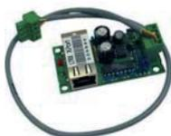
Scheda di conversione da porta seriale RS232 a Ethernet 10/100 Mbit/s per la centrale FIREscape EL-2. Può essere installata fino ad una distanza massima dalla centrale di 200m, può essere alimentata dalla centrale.
