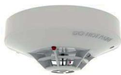
Rivelatore termico a risposta statica 90°C indicati dalla lettera "C", corrispondente alla "Classe C" e alla "Classe CS" nella classificazione EN54. Doppio led di segnalazione allarme visibile a 360°. Morsetto di uscita per lampada ripetitrice. Alimentazione 9,5-30 Vdc. Basso profilo altezza 38mm, diametro 100mm. Colore AVORIO. Certificato EN 54-5: 2000 + A1:2002. Compatibile con le basi della serie YBN-R/6 e YBO-R/6.
