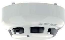
Rivelatore di fumo fotoelettronico analogico indirizzato, con nuova camera di rivelazione High Performance, indirizzamento elettronico, camera ottica rimovibile, doppio Led di segnalazione (verde in polling, rosso in allarme), consumo 120 microA in Low Power, basso profilo, altezza 45 mm, diametro 100 mm. Colore BIANCO. Certificato EN 54-7. Compatibile con le basi della serie YBN-R/3(WHT) e YBN-R/3(SCI)WHT.
