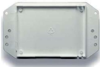
Adattatore per moduli "Smart Fix". Supporto su cui fissare la scheda dei moduli attuali per poter utilizzare i fissaggi, delle installazioni esistenti, in caso di sostituzione di moduli precedenti ed obsoleti.
