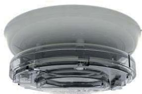
Sirena con lampeggiante a led ROSSI, basso assorbimento, indirizzata e alimentata dal loop certificata SIL2. 51 tonalità selezionabili, volume selezionabile da 50 a 98 dB(A). Categoria di appartenenza del flash "O". Colore AVORIO. Può fungere da base per un rivelatore o essere montata da sola con coperchio SI/CAP2. Temperatura di funzionamento -10°C +50°C. Grado di protezione IP21. Certificata EN 54-3 e EN 54-23. Compatibile con le basi della serie YBN-R/3 e YBN-R/3(SCI)/SIL.
