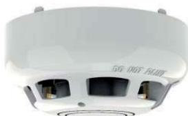
Rivelatore combinato fotoelettronico e di temperatura analogico indirizzato certificato SIL2, con nuova camera di rivelazione High Performance, indirizzamento elettronico, camera ottica rimovibile, doppio Led di segnalazione (verde in polling, rosso in allarme), consumo 400 microA, basso profilo, altezza 45mm, diametro 100 mm. Colore BIANCO. Certificato EN 54-5 e EN 54-7. Compatibile con le basi YBN-R/3(WHT)-SCI/SIL e YBN-R/3(WHT).
