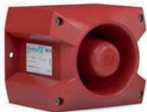
Sirena elettronica per interni/esterni a basso assorbimento, completa di back box per entrata cavi, potenza acustica 105 dB (portata EN54 r=32m), 80 toni selezionabili, alimentazione 10-57Vdc assorbimento 6-80mA, temperatura di esercizio -40° +55°C. Contenitore in policarbonato e ABS di colore ROSSO, dimensioni 164x135x132 mm (LxHxP). Grado di protezione IP66. Certificata EN 54-3, VdS, GOST, UL, GL (codice d'ordine specifico per GL).
