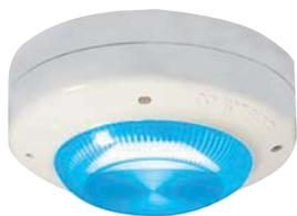
Lampeggiante analogico indirizzato, LED ad alta intensita` per una visibilita` eccellente anche in condizioni sfavorevoli di luminosit`. Basso assorbimento e alimentazione diretta dal loop. Frequenza di lampeggio 1Hz. Colore AVORIO e lampeggiante BLU. Compatibile con le basi della serie YBN-R/3 o YBN-R/3(SCI) o sirene YBO-BS e YBO-BSB2.
