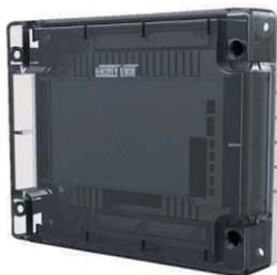
Modulo indirizzato su loop, certificato SIL2, a 2 ingressi singolarmente programmabili come N/A o N/C. Alimentazione diretta dal loop, consumo a riposo 280 microA. Led di segnalazione visibile a coperchio chiuso. Contenitore "Smart Fix" con coperchio trasparente. Dimensioni 157x127x35mm. Completo di isolatori di corto circuito integrati direttamente sul modulo. Certificato EN 54-18:2005 ed EN 54-17:2005. Indirizzamento tramite dip switch presenti sul modulo.
