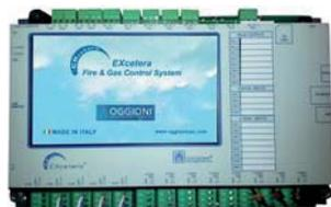
Centrale Open frame con display Touch TFT 7". Quattro linee seriali RS485 per un massimo complessivo di 250 dispositivi (rivelatori e moduli di I/O). Una linea seriale per il collegamento verso sistemi remoti. Otto uscite a relè integrate di cui 7 liberamente programmabili. Otto ingressi analogici 4-20mA integrati e quattro ingressi digitali. Alimentazione 24Vdc. Batteria collegabile 7,2Ah. Possibilità di fornirlo nel cabinet cod. EXcetra-BOX10
