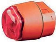
Sirena elettronica convenzionale a basso assorbimento, combinata con lampeggiante strobo NON certificato EN54-23, completa di base rialzata, potenza acustica 110 dB a 1 m, 32 toni selezionabili, Lampeggiatore da 1 W 60 impulsi al min, alimentazione 9-30 Vdc, assorbimento sirena massimo 39mA, lampeggiante 40mA, temperatura di funzionamento da -20°C a +55°C. Contenitore in materiale termoplastico colore ROSSO, altezza 105mm, diametro 92mm. Grado di protezione IP66. Certificata EN 54-3.
