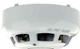
Rivelatore combinato termomassimale + termovelocimetrico analogico indirizzato certificato SIL2, indirizzamento elettronico, doppio Led di segnalazione (verde in polling, rosso in allarme), consumo 350 microA, basso profilo, altezza 45mm, diametro 100 mm. Colore BIANCO. Certificato EN54-5. Compatibile con le basi YBN-R/3(WHT)-SCI/SIL e YBN-R/3(WHT).
