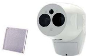
Rivelatore lineare ottico di fumo a riflessione con gruppo ottico motorizzato, completo di riflettore portata 5- 50 metri. Disponibile kit riflettori aggiuntivo 5-120m. Sistema di puntamento (mirino laser) montato sul gruppo ottico.
