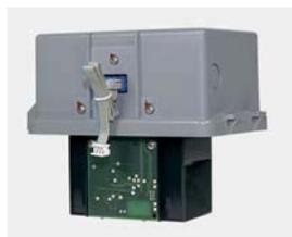
Rivelatore ottico ad alta sensibilità per unità di analisi ASD 532. Sensibilità allarme: min. 10%-max.0.02 %. Il preallarme può essere impostato fino a 10 volte più sensibile. Es. 0.002% obs/m. Temperatura di lavoro -20°C a + 60°C. Dimensioni: 95 (L) x 145 (H) x 120 (P) mm.
