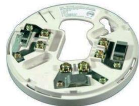
Base standard per rivelatori convenzionali a sicurezza intrinseca; contatti ad innesto autopulenti, morsetto d'appoggio per schermo. Colore BIANCO altezza 8mm diametro 100mm.
