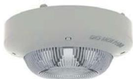
Indicatore remoto indirizzato a LED alimentato da loop. Colore AVORIO e lente TRASPARENTE. Compatibile con le basi della serie YBN-R/3 o YBN-R/3(SCI) o sirene YBO-BS e YBO-BSB2.
