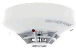
Rivelatore termico a risposta statica 90°C indicati dalla lettera "C", corrispondente alla "Classe C" e alla "Classe CS" nella classificazione EN54. Doppio led di segnalazione allarme visibile a 360°. Morsetto di uscita per lampada ripetitrice. Alimentazione 9,5-30 Vdc. Basso profilo altezza 38mm, diametro 100mm. Colore BIANCO. Certificato EN 54-5: 2000 + A1:2002. Compatibile con le basi della serie YBN-R/6 e YBO-R/6.
