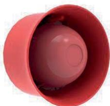
Sirena basso assorbimento indirizzata su loop per montaggio a parete di colore ROSSO, 51 tonalita` selezionabili, volume selezionabile da 90 a 102 dB(A), tempo di suonata impostabile fino a 18 ore. Colore ROSSO. Grado di protezione IP21 innalzabile al grado di protezione IP65 con l'utilizzo dell'accessorio cod. CHQ-WPK. Certificata EN 54-3. Compatibile con le basi della serie YBO-R/3(RED), YBO-R/SCI(RED).
