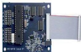
Interfaccia FIRELINK Apic con Protocollo Hochiki ESP per interfacciamento su Loop analogico centrali incendio. Può essere installata sulle unità serie FIRELINK e fornisce indicazioni sullo stato dell'unità di aspirazione (o di più unità di aspirazione se installata su FIRELINK 400CM O FIRELINK-CM) direttamente sulla centrale rivelazione incendio.
