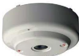
Rivelatore di fiamma all'infrarosso, con singola tecnologia IR. Prestazioni in classe 1 come da normativa EN54-10:2002 (copertura fino a 25m, con cono di 90°). Doppio led di segnalazione allarme visibile a 360°. Morsetto di uscita per lampada ripetitrice. Alimentazione 15-30 Vdc. Dim.: altezza 37,3 mm, diametro 100 mm. Colore AVORIO. Certificato EN 54-10: 2002. Compatibile con le basi della serie YBN-R/6 e YBO-R/6.
