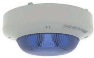
Lampeggiante analogico indirizzato, LED ad alta intensita` per una visibilita` eccellente anche in condizioni sfavorevoli di luminosit`. Basso assorbimento e alimentazione diretta dal loop. Frequenza di lampeggio 1Hz. Colore BIANCO e lampeggiante BLU. Compatibile con le basi della serie YBN-R/3(WHT) o YBN-R/3(WHT)-SCI o sirene YBO-BS(WHT) e YBO-BSB2/..(WHT).
