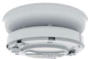
Sirena basso assorbimento indirizzata su loop certificata SIL2. 51 tonalità selezionabili, volume selezionabile da 50 a 98 dB(A), tempo di suonata impostabile fino a 18 ore. Colore BIANCO. Può fungere da base per un rivelatore o essere montata da sola con coperchio SI/CAP2(WHT). Temperatura di funzionamento -10°C +50°C. Grado di protezione IP21. Certificata EN54-3. Compatibile con le basi della serie YBN-R/3(WHT) e YBN-R/3(WHT)-SCI/SIL.
