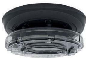
Sirena con lampeggiante a led ROSSI, basso assorbimento, indirizzata e alimentata dal loop. 51 tonalita` selezionabili, volume selezionabile da 50 a 98 dB(A). Categoria di appartenenza del flash "O". Colore NERO. Puo` fungere da base per un rivelatore o essere montata da sola. Grado di protezione IP21. Certificata EN 54-3 e EN 54-23. Compatibile con le basi della serie YBN-R/3(BLK).
