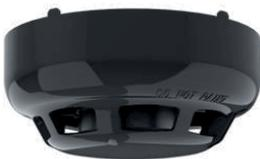
Rivelatore di fumo fotoelettronico analogico indirizzato, con nuova camera di rivelazione High Performance, indirizzamento elettronico, camera ottica rimovibile, doppio Led di segnalazione (verde in polling, rosso in allarme), consumo 120 microA in Low Power, basso profilo, altezza 45 mm, diametro 100 mm. Colore NERO. Certificato EN 54-7. Compatibile con le basi della serie YBN-R/3(BLK).
