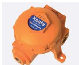
Serie di sensori di Gas Esplosivi in esecuzione Ex-n con elemento sensibile Pellistor anti-avvelenamento; Uscita 4-20 mA.; Temperatura di esercizio -40°C/ +55°C. Contenitore in Alluminio, M20, EN61179 N.B. Non è utilizzabile in Aree a Rischio di Esplosione.
