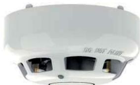
Rivelatore combinato termomassimale + termovelocimetrico analogico indirizzato, indirizzamento elettronico, doppio Led di segnalazione (verde in polling, rosso in allarme), consumo 350 microA, basso profilo, altezza 45mm, diametro 100 mm. Colore BIANCO. Certificato EN54-5. Compatibile con le basi della serie YBN-R/3(WHT) e YBN-R/3(SCI)WHT.
