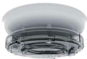
Sirena con lampeggiante a led ROSSI, basso assorbimento, indirizzata e alimentata dal loop. 51 tonalita` selezionabili, volume selezionabile da 50 a 98 dB(A). Categoria di appartenenza del flash "O". Colore BIANCO. Puo` fungere da base per un rivelatore o essere montata da sola con coperchio SI/CAP2(WHT). Grado di protezione IP21. Certificata EN 54-3 e EN 54-23. Compatibile con le basi della serie YBN-R/3(WHT) e YBN-R/3(SCI)WHT.
