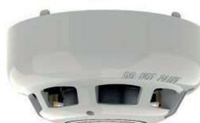
Rivelatore combinato fotoelettronico e di temperatura analogico indirizzato, con isolatore di corto circuito e nuova camera di rivelazione High Performance, indirizzamento elettronico, camera ottica rimovibile, doppio Led di segnalazione (verde in polling, ambra se isolato, rosso in allarme), consumo 400 microA, basso profilo, altezza 45mm, diametro 100 mm. Colore AVORIO. Certificato EN 54-5 e EN 54-7. Compatibile con le basi della serie YBV-R/4.
