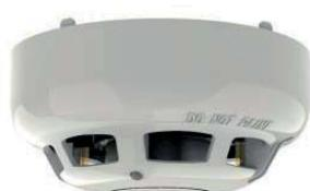
Rivelatore combinato termomassimale + termovelocimetrico analogico indirizzato, con isolatore di corto circuito, indirizzamento elettronico, doppio Led di segnalazione (verde in polling, ambra se isolato, rosso in allarme), consumo 350 microA, basso profilo, altezza 45mm, diametro 100 mm. Colore AVORIO. Certificato EN54-5. Compatibile con le basi della serie YBV-R/4.
