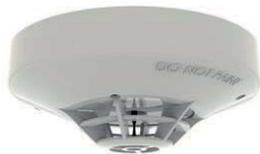
Rivelatore combinato termomassimale + termovelocimetrico analogico indirizzato, indirizzamento elettronico, doppio Led di segnalazione, consumo 350 microA, basso profilo, altezza 41mm, diametro 100 mm. Materiale ABS di colore AVORIO. Versione stagna IP 67 con connessioni a filo (no morsetti). Certificato EN 54-5. NON richiede basi di fissaggio. Necessita del programmatore portatile TCH-B200 per l'indirizzamento.
