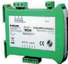
Modulo indirizzato su loop con 1 uscita a relé con contatto in scambio libero da tensione, portata 48Vcc/2A – 250Vca/5A (carico resistivo) e 1 ingresso monitorato. Alimentazione diretta da loop, consumo a riposo 300 micro A. Led di segnalazione. Contenitore per montaggio su barra DIN. Morsettiere estraibili. Dimensioni 119x108x24mm. Completo di isolatori di cortocircuito integrati direttamente su modulo. Certificato EN 54-18:2005 ed EN 54-17:2005. Indirizzamento tramite dip switch sul modulo.
