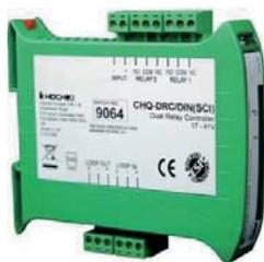
Modulo indirizzato su loop con 2 uscite a relé con contatto in scambio libero da tensione, portata 30Vcc/1A (carico resistivo) e 1 ingresso monitorato. Alimentazione diretta da loop, consumo a riposo 300 microA. Led di segnalazione. Contenitore per montaggio su barra DIN. Morsettiere estraibili. Dimensioni 119x108x24mm. Completo di isolatori di corto circuito integrati direttamente sul modulo. Certificato EN 54-18:2005 ed EN 54-17:2005. Indirizzamento tramite dip switch presetni sul modulo.
