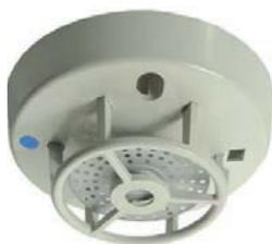
Rivelatore di temperatura in versione stagna IP67, tecnologia a lamina bimetallica. Temperatura di intervento 60°C. Led di segnalazione allarme. Uscita per lampada ripetitrice. Alimentazione 15-30Vdc. Dim.: altezza 45 mm, diametro 98 mm. Colore AVORIO. Certificato EN 54-5: 2000 + A1:2002. Non richiede base di montaggio collegamento tramite cavi fili "volanti".
