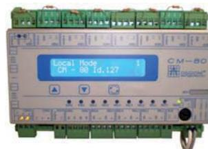
Centralina programmabile da operatore - 2 loop seriali RS485 + 2 ingressi digitali + 6 uscite relè. Supporta fino a 48 rilevatori di gas in loop seriale RS485 Protocollo ModBus RTU. 2 livelli di allarme programmabili per ogni canale. Memoria eventi con reset sotto password. 2 Uscite relè pre-programmate: (Guasto e uscita sirena tacitabile). 4 Uscite relè programmabili da operatore sotto password. Batteria collegabile 7,2Ah. Alimentazione 24Vdc. Versione montaggio a barra DIN.
