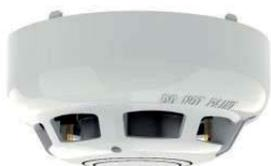
Rivelatore combinato fotoelettronico e di temperatura analogico indirizzato, con nuova camera di rivelazione High Performance, indirizzamento elettronico, camera ottica rimovibile, doppio Led di segnalazione (verde in polling, rosso in allarme), consumo 400 microA, basso profilo, altezza 45mm, diametro 100 mm. Colore BIANCO. Certificato EN 54-5 e EN 54-7. Compatibile con le base della serie YBN-R/3(WHT) e YBN-R/3(SCI)WHT.
