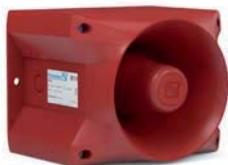
Sirena elettronica per interni/esterni ad alta potenza sonora, completa di back box per entrata cavi, potenza acustica 120 dB (portata EN54 r=178m), 80 toni selezionabili; alimentazione 10-60Vdc assorbimento 120-880mA, temperatura di funzionamento -40° +55°C. Contenitore in policarbonato e ABS di colore rosso. Dimensioni 214x170x181 mm (LxHxP). Grado di protezione IP66. Certificata EN 54-3, VdS, GOST, UL, GL (codice d'ordine specifico per GL).
