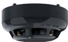
Rivelatore combinato termomassimale + termovelocimetrico analogico indirizzato, indirizzamento elettronico, doppio Led di segnalazione (verde in polling, rosso in allarme), consumo 350 microA, basso profilo, altezza 45mm, diametro 100 mm. Colore NERO. Certificato EN54-5. Compatibile con le basi della serie YBN-R/3(BLK).
