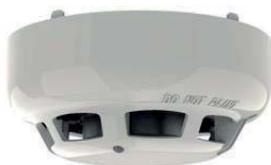
Rivelatore di fumo fotoelettronico analogico indirizzato certificato SIL2, con nuova camera di rivelazione High Performance, indirizzamento elettronico, camera ottica rimovibile, doppio Led di segnalazione (verde in polling, rosso in allarme), consumo 120 microA in Low Power, basso profilo, altezza 45 mm, diametro 100 mm. Colore AVORIO. Certificato EN 54-7. Compatibile con le basi YBN-R/3(WHT)-SCI/SIL e YBN-R/3(WHT).
